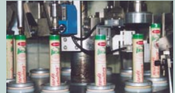
Remplissage des tubes de Moutarde
